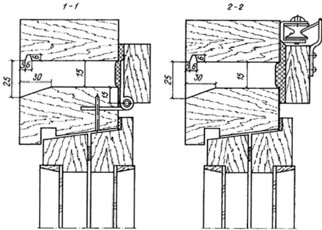
**Рис. 1. Регулируемое приточное устройство**
