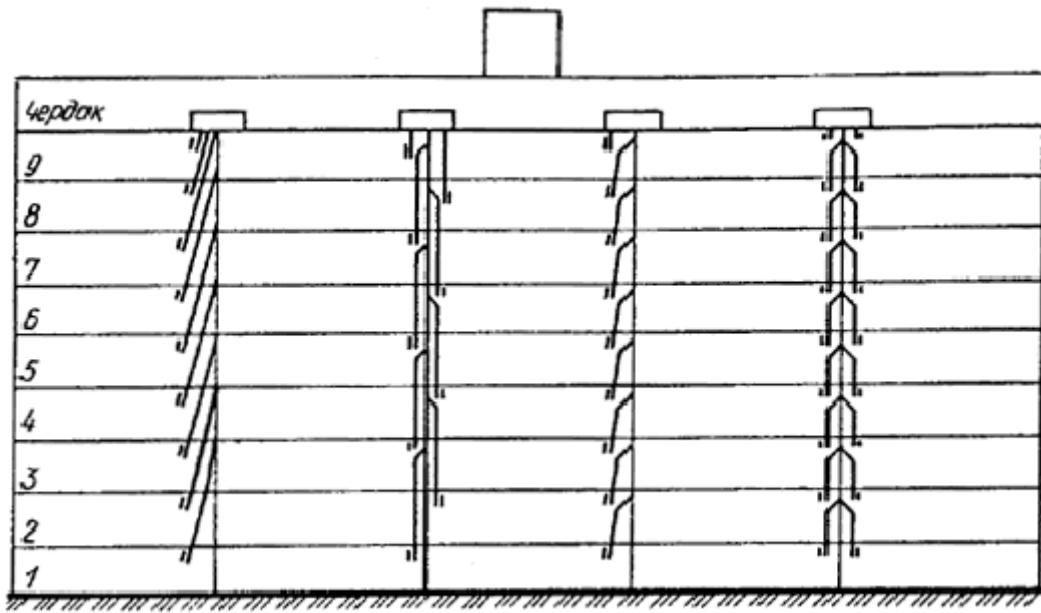
**Рис. 2. Возможные схемы естественной канальной вытяжной вентиляции**
